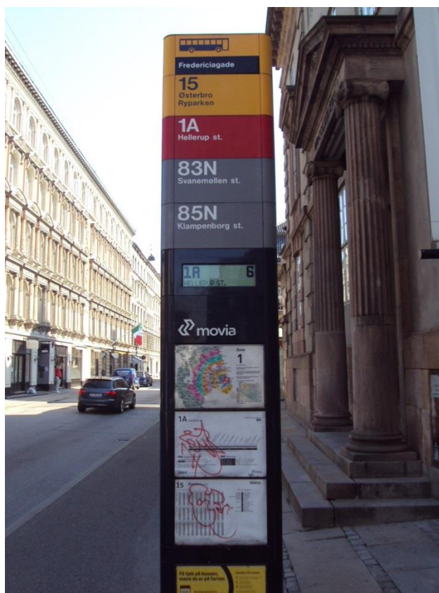
Rys. 11.1. Tablica elektroniczna oraz gablota informacyjna wkomponowane w konstrukcję słupka przystankowego (Kopenhaga). Źródło: materiały własne.
